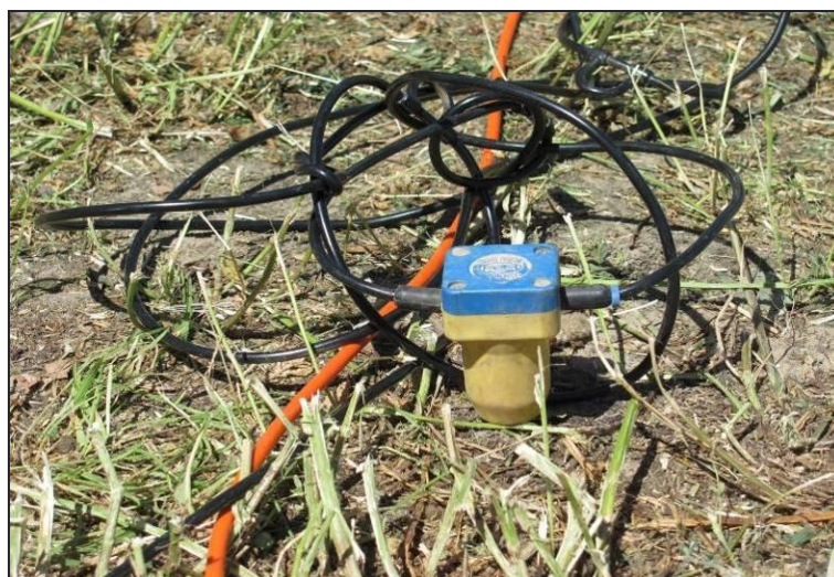
Fot. 1 Geofon podłączony do kabla przesyłowego. (Arch. PGNiG SA)
