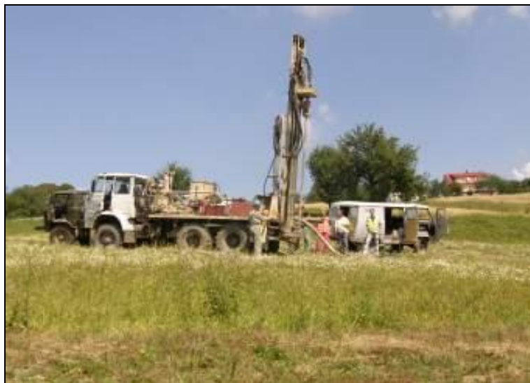
Fot. 5 Samojezdne urządzenie do wiercenia otworów strzałowych. (Arch. PGNiG SA)
