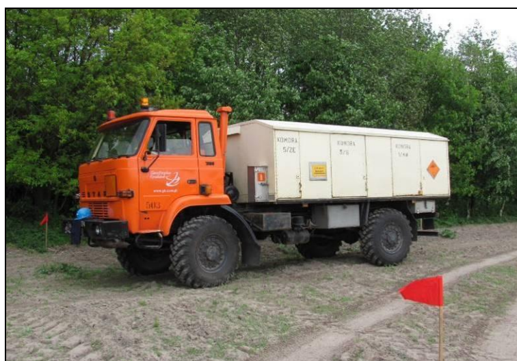
Fot. 16 Samochód „magazyn” do transportu materiałów wybuchowych w terenie. (Arch. PGNiG SA)
