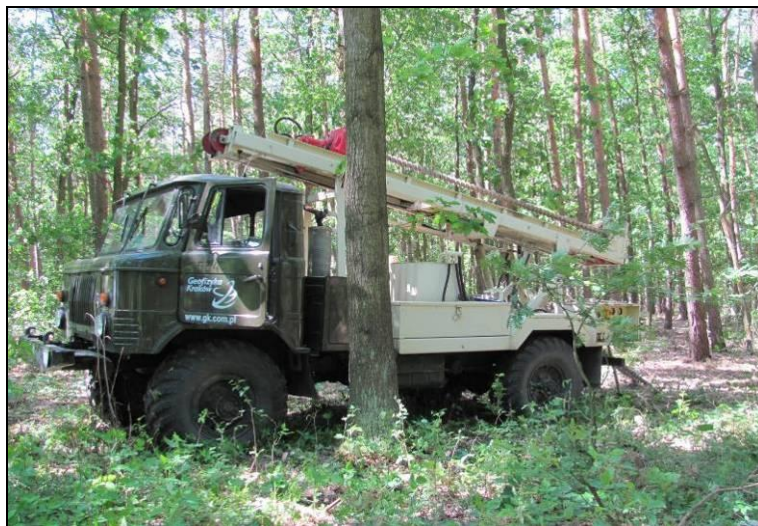
Fot. 6 Samojezdne urządzenie do wiercenia otworów strzałowych. (Arch. PGNiG SA)
