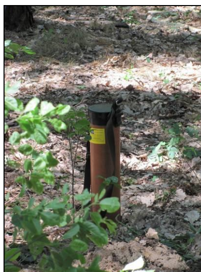
Fot. 15 Pojemnik do transportu materiału wybuchowego na punkt pomiarowy. (Arch. PGNiG SA)
