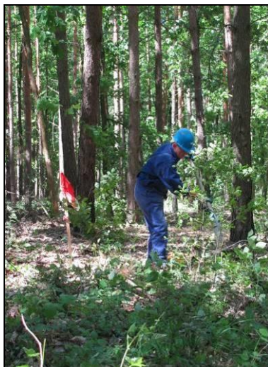
Fot. 26 Po umieszczeniu ładunku wybuchowego otwór jest przysypywany ziemią. (Arch. PGNiG SA)
