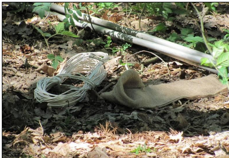
Fot. 20 Materiały potrzebne do umieszczenia ładunku wybuchowego w otworze. (Arch. PGNiG SA)
