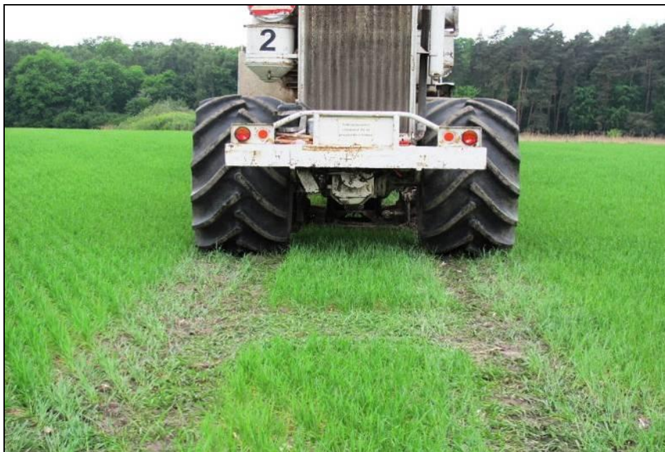
Fot. 33 Ślady powstałe w wyniku przejazdu zestawu wibratorów oraz odcisnięty ślad po płycie wibracyjnej. (Arch. PGNiG SA)
