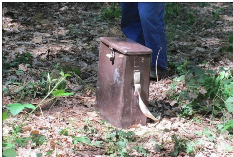
Fot. 17 Pojemnik do transportu w terenie materiałów do uzbrojenia ładunku wybuchowego w otworze strzałowym. (Arch. PGNiG SA)
