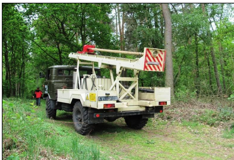
Fot. 7 Samojezdne urządzenie do wiercenia otworów strzałowych. (Arch. PGNiG SA)
