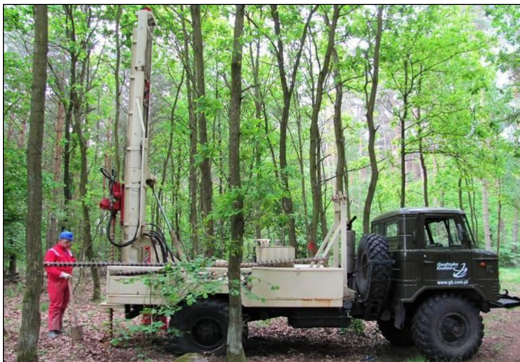
Fot. 4 Samojezdne urządzenie do wiercenia otworów do pomiaru strefy małych prędkości - SMP. (Arch. PGNiG SA)
