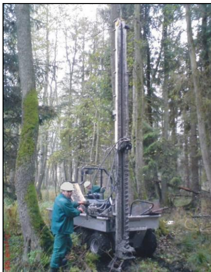
Fot. 9 Samojezdne urządzenie do wiercenia otw. strzałowych w trudnych warunkach terenowych, charakteryzujące się znikomą inwazyjnością w środowisko. (Arch. PGNiG SA)
