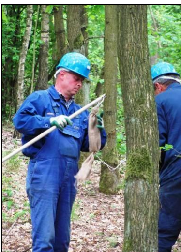
Fot. 24 Worek z uzbrojonym ładunkiem wybuchowym zaczepiany jest na haczyku rurki, za której pomocą zostanie umieszczony w otworze strzałowym. (Arch. PGNiG SA)
