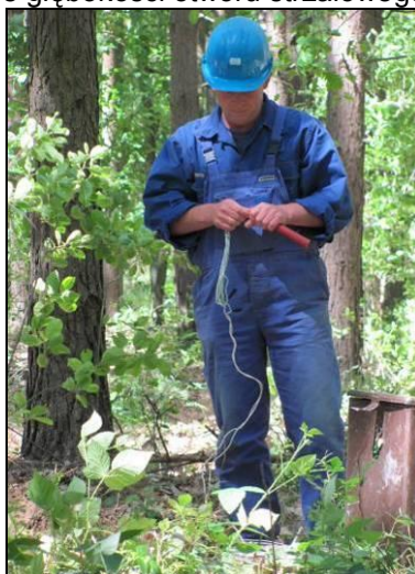
Fot. 22 Zbrojenie ładunku wybuchowego. (Arch. PGNiG SA)
