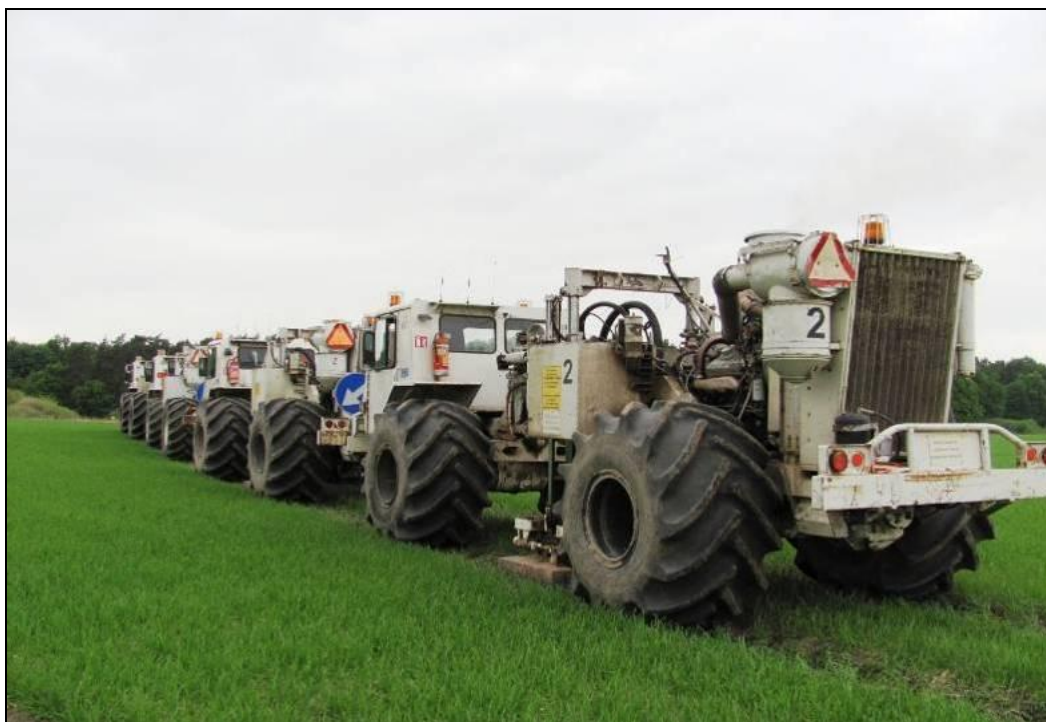
Fot. 3 Zestaw wibratorów na punkcie wzbudzeniowym. (Arch. PGNiG SA)
