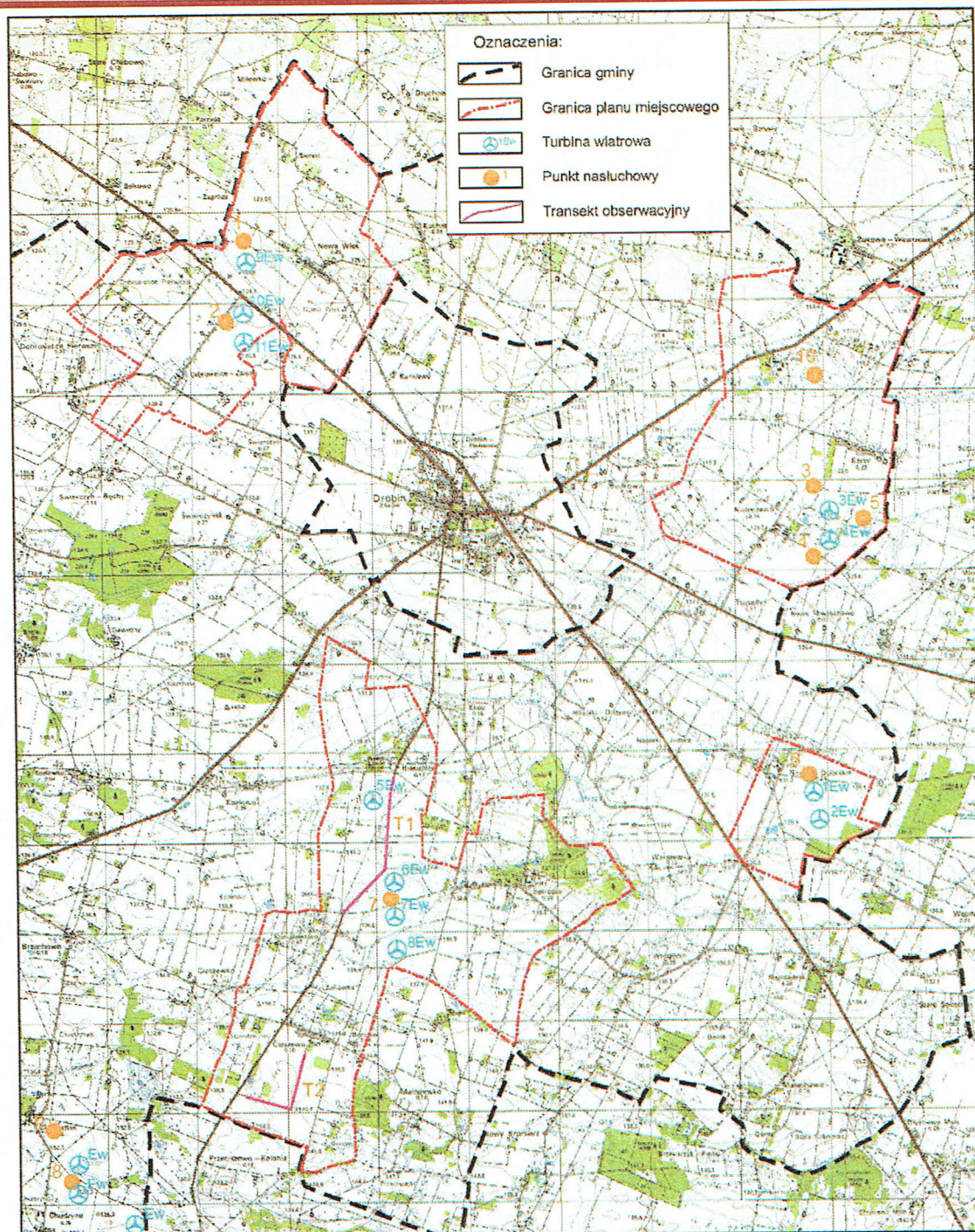
Rysunek 3. Rozmieszczenie turbin, przebieg transektów, lokalizacja punktów nasłuchowych
